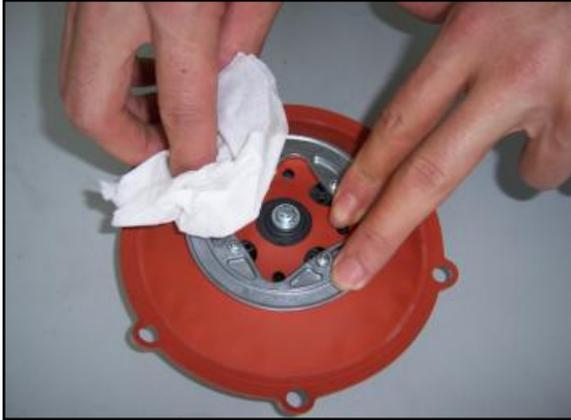
**Nettoyage de diaphragme :** Nettoyez avec un coton propre la poussière ou la tache d'huile sur le diaphragme, si il y a une pollution grave sur le diaphragme, vous pouvez tremper le coton dans une petite quantité d'agent de nettoyage pour essuyer. Lors du nettoyage du diaphragme, faites attention à voir si il y a les fissures ou les pièces d'usure sur le diaphragme, quand il y a un tel phénomène, il est nécessaire de remplacer le diaphragme.
