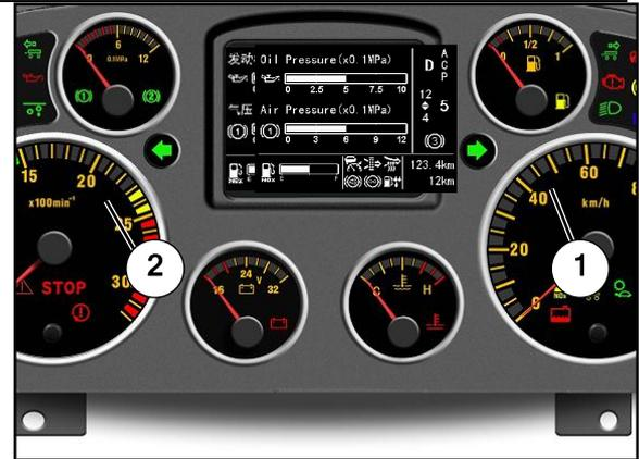
La clé se connecte avec l'électricité, et pressez en même temps sur le bouton 1 et bouton 2 pour 10 secondes, le système entre dans le mode de diagnostic. Pressez longuement le bouton 1 pour quitter le mode, lorsque la rotation du moteur ≥ 300rpm ou la vitesse de véhicule ≥ 5km/h, il est aussi possible de quitter le mode. L'afficheur de conduite se divise en sept zones selon les fonctions
